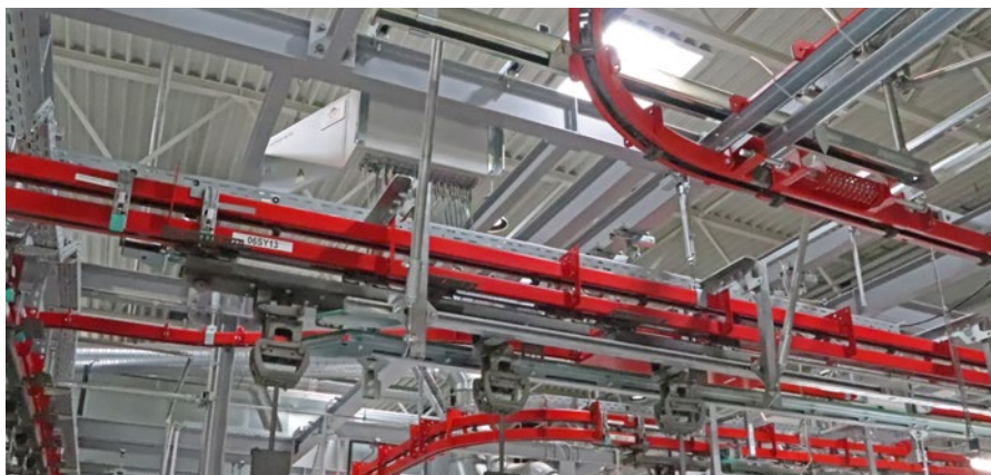
Für die Beschichtung der unterschiedlichen Motorradrahmen bedarf es einer hohen Flexibilität in Bezug auf die Anzahl und Abfolge der einzelnen Bearbeitungsstationen.
