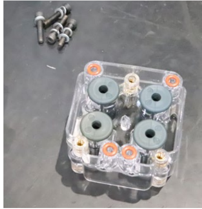
Die vier Quetschventile in einer HDLV-Pumpe müssen nur selten gewechselt werden.
