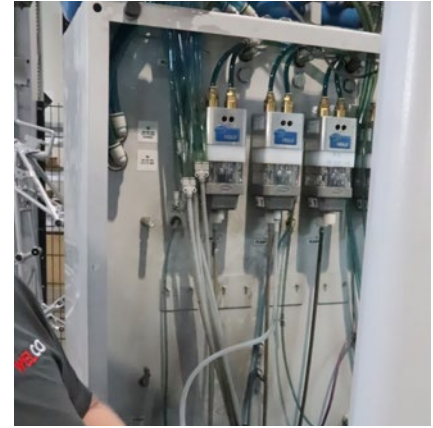
HDLV-Pumpen arbeiten mit Unterdruck – ist der i.O., stimmt auch die Pulverförderung.
