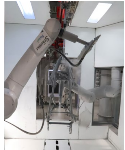
Die weiche Wolke versetzt die Roboter in die Lage, auch schwierige Zonen zu beschichten.
